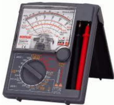
รูปที่ 3.3 แสดงลักษณะภายนอกของมัลติมิเตอร์ยี่ห้อ รุ่น YX-360TRD
